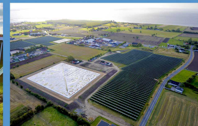
1996: Marstal Fjernvarme installerer solpaneler, 15 % af forbruget 2002: Marstal Fjernvarme fordobler andelen af solvarme 2012: Marstal Fjernvarme dækker nu 50 % af forbruget med sol 2012: Marstal Fjernvarme bygger damvarmelager med 75 mill. l. vand
