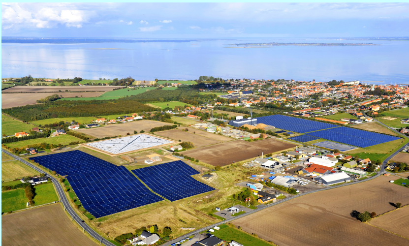
Den hvide firkant med krydset i midten er et enormt varmtvandslager med 75 mill. m 3 vand
